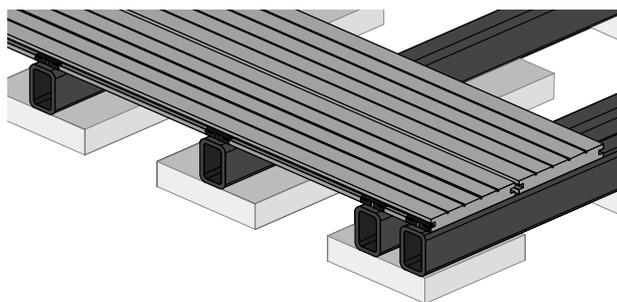
Grundsätzlich muss jeder Stoß/Versatz so angeordnet werden, dass die jeweilige Diele am Versatz **an einer separaten Unterkonstruktion und einem separaten Clip** im Stoßbereich befestigt werden kann. So wird eine gleichmäßige Kraftübertragung möglich.
