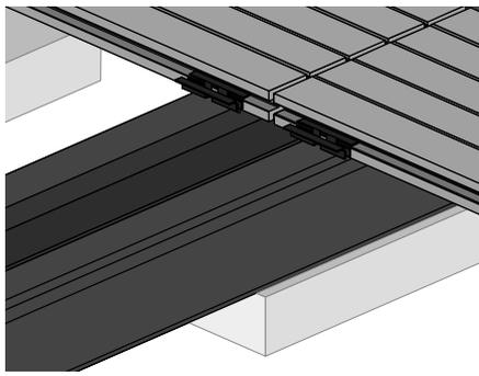
Aufgrund der Verlegeart oder Größe einer Terrasse kann es notwendig sein, Dielen in der Länge zu stoßen. Halten Sie einen entsprechenden **Abstand von 7 mm** zwischen den Kopfseiten der Dielen ein. Der Stoß muss grundsätzlich auf zwei UK-Leisten erfolgen (s. Abb.).
