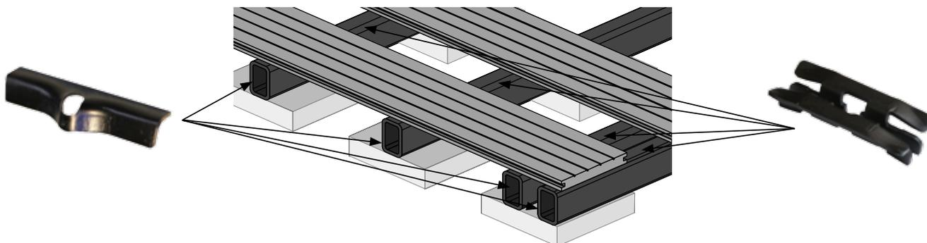
Die letzte Diele befestigen Sie wieder mit dem Anfangs-/Endclip. Die Terrassendielen müssen grundsätzlich an jedem Auflagepunkt der Unterkonstruktion mittels des Clips auf beiden Seiten befestigt werden. Dabei ist darauf zu achten, dass die Terrassendielen vollflächig auf der Unterkonstruktion aufliegen.
