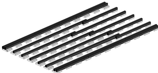
Beachten Sie bitte, dass Steckverbinder auf Fundamentplatten platziert sein müssen – sie sind keine kraftübertragenden Elemente. (Beachten Sie hierzu unsere Verlegeanleitung für die HQ-Alu Unterkonstruktion)
