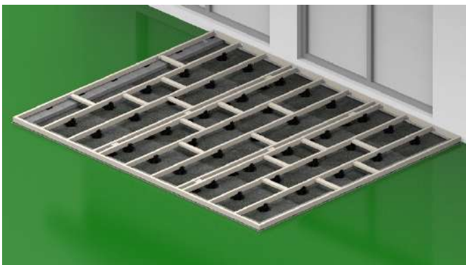
14. Wenn alle Unterkonstruktionen an der Rahmenkonstruktion angeschraubt worden sind, können die Verstellsfüße exakt ausgerichtet werden.
