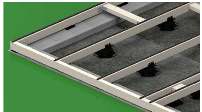
15. Je nach verwendete Produkt sollte entweder auf jeder Unterkonstruktion eine ca. 5 mm starke Abstandsschnur oder Abstandshalter montiert werden. Damit kann die Gebrauchsklasse GK 3.1 erzielt werden und die Nutzungsdauer der Terrasse wird verlängert.
